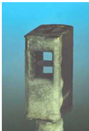
VAセンサ使用例（粉塵が付着状態ですが計測可能です。） * 超音波センサカバーに堆積物がある場合は除去してください。
