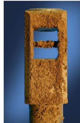
VAセンサ使用例（粉塵が付着状態ですが計測可能です。）
