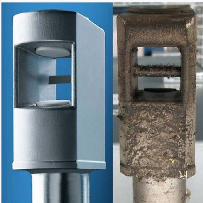
廃水処理における下水ガス・バイオガス量測定
