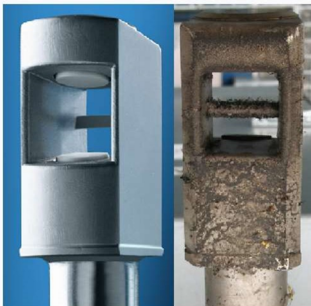
ヴォルテックス式センサのヘッド部 通常/粉塵付着(使用可能)
