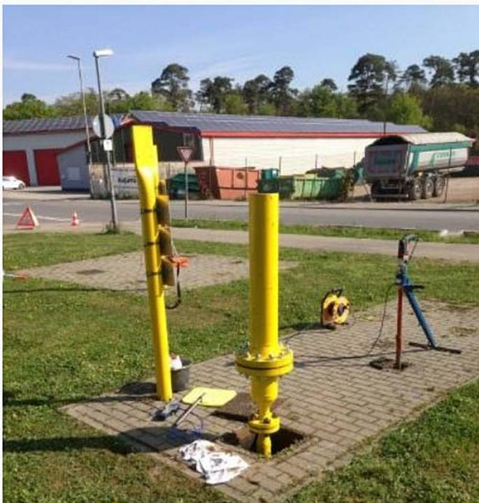
天然ガスラインのガスブローワーでの体積流量の測定。
