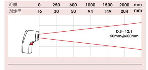
測定対象物から600mmの距離で直径50mmの平均温度を測定。測定視野範囲は光学応答の90%の測定径です。測定対象物の大きさは上図より十分大きいことが必要です。
